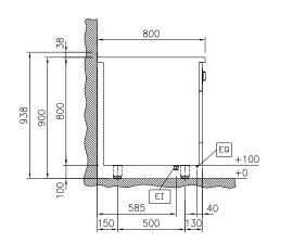
Electrical inlet (power) Equipotential screw
